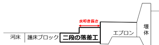
図1 二段の落差工の設置
